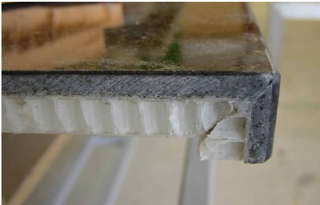
Realizzazione del giunto a 45° 45° joint manufacturing
